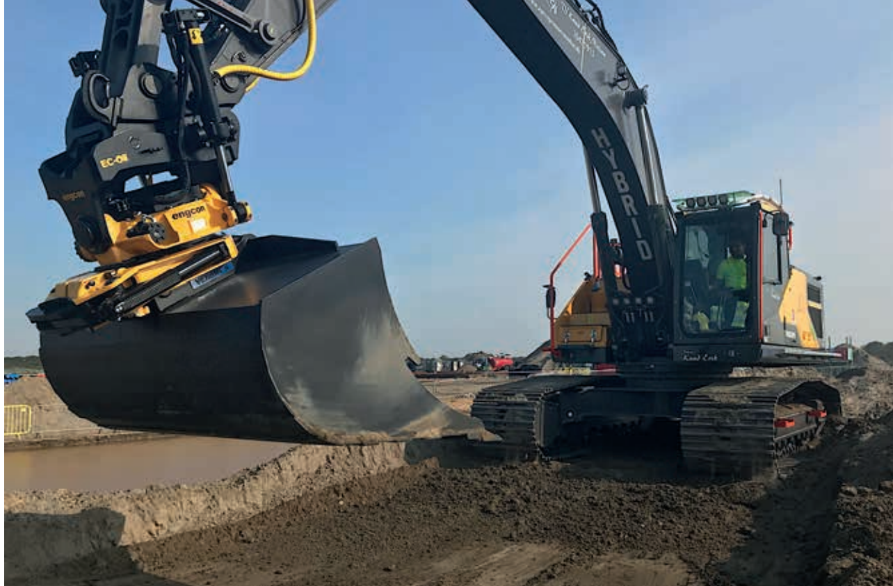
Modelnavnet er EC300EL Hybrid. Maskinen er grundlæggende en traditionel EC300 men med integreret hybridteknologi.
