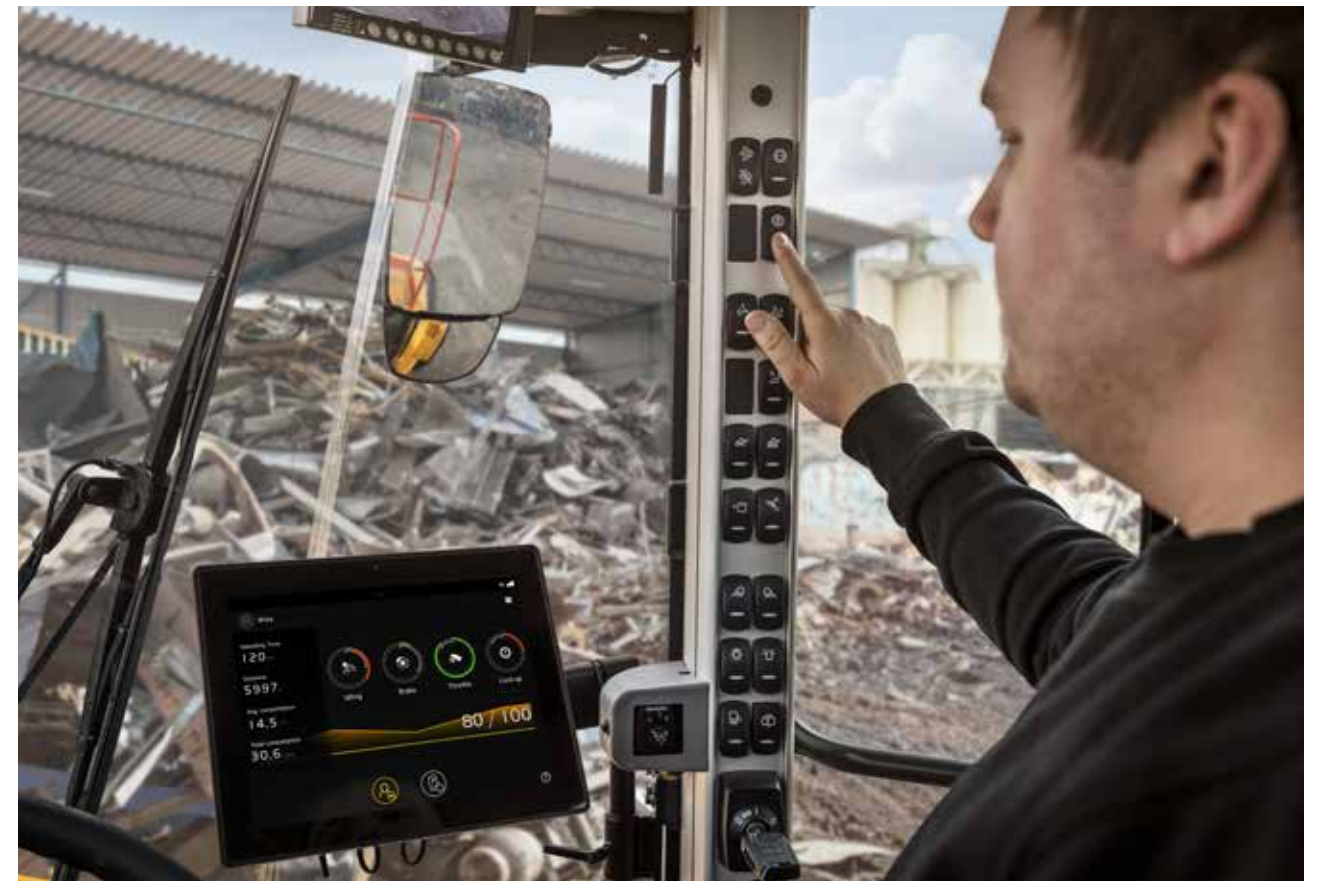
Den 10-tommer store touchskærm i førerhuset giver afhængigt af maskinmodellen adgang til flere Load Assist-applikationer, hvor der netop er tilføjet flere nye.
