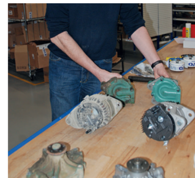
En ombytningsgenerator. Ofte er alene huset genbrugt, mens alle sliddele er udskiftet uanset slitage.
