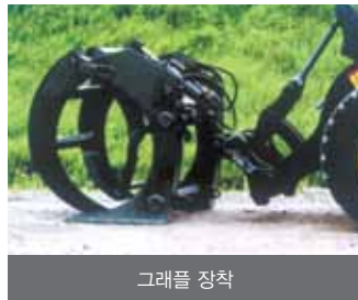
브라켓(링크) 이용한 빠른 버킷 탈부착
