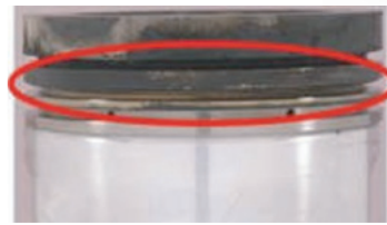
시중 오일(테스트 실패) 퇴적물이 명확하게 표시됨
