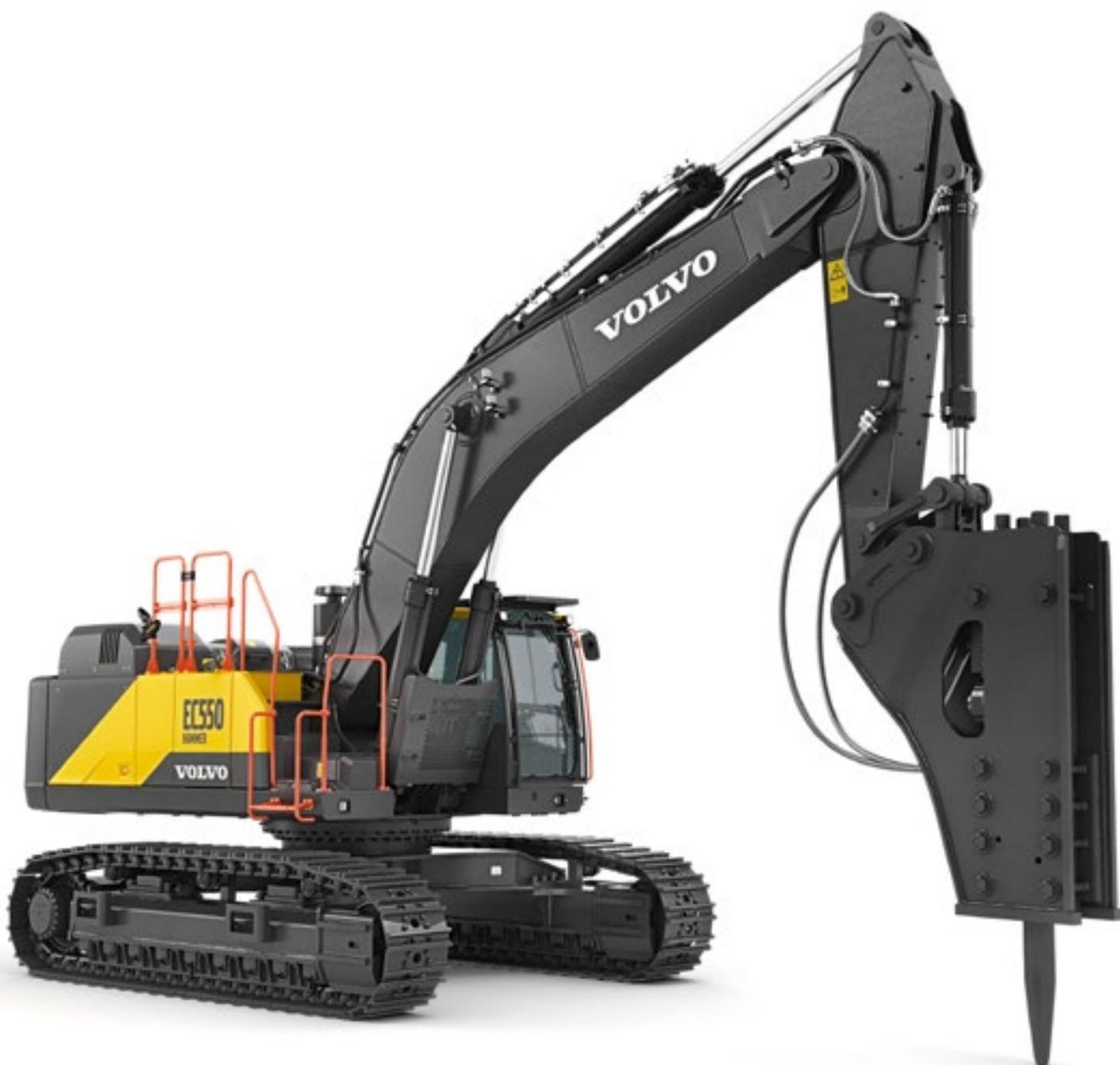
沃尔沃挖掘机(破碎锤版) 56.9-57.3 t 320 kW
