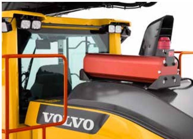
Sistema de detecção de objetos por radar
