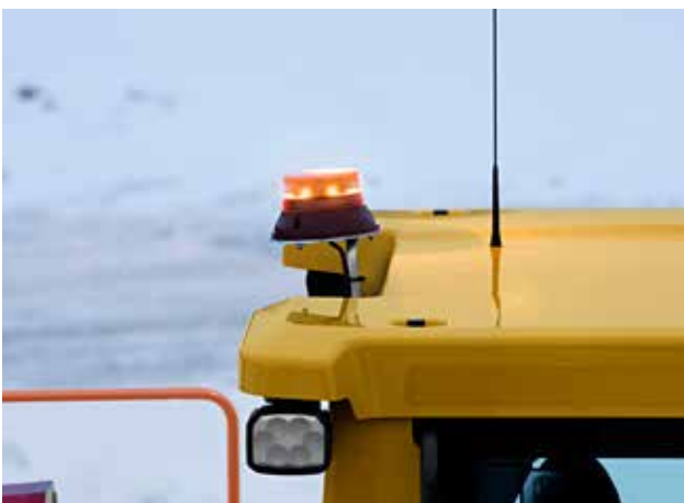
Luz de advertencia rotativa de tipo LED
