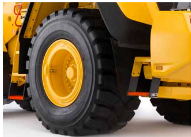
Pneus arrière avec ballast liquide
