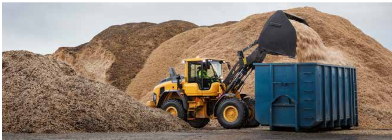
Łyżka Volvo do materiałów lekkich o bardzo małej gęstości | Mocowanie sworzniowe
