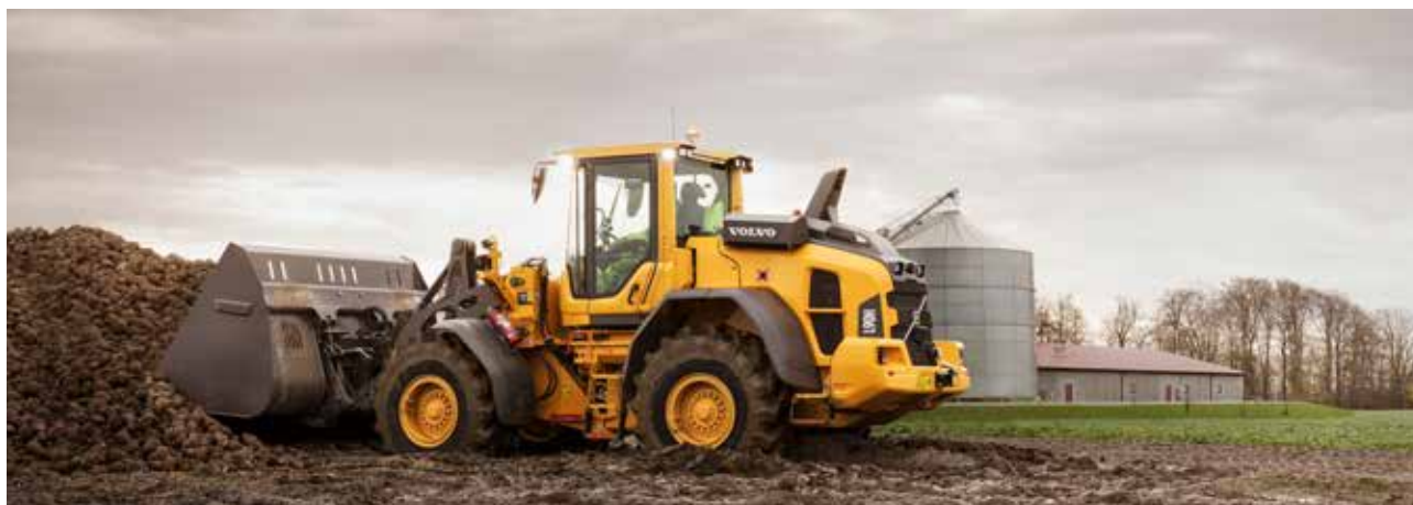
Cuchara para material ligero Volvo – Baja densidad | Conexión de tipo bulón
