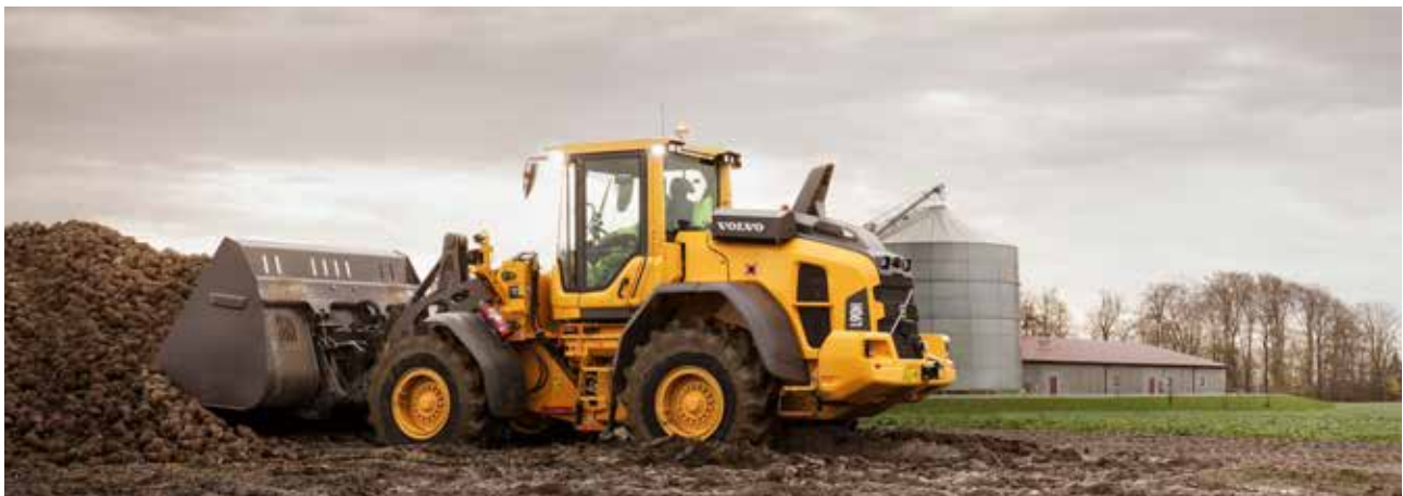
Volvo Leichtmaterial-Schaufel - niedrige Dichte | Aufsteckschnittstelle
