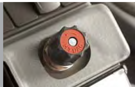
Hand-inching voor in te stellen kruipsnelheid
