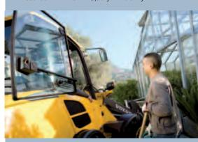
Полностью открываемое боковое окно обеспечивает хорошую вентиляцию.
