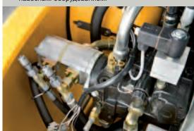
Отдельные гидравлические насосы для рабочего оборудования и рулевого управления.
