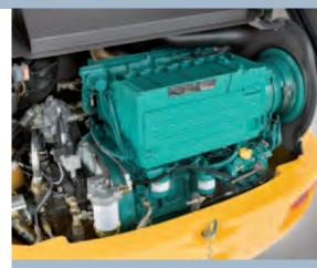
Высокопроизводительный 4-цилиндровый дизельный двигатель Volvo.
