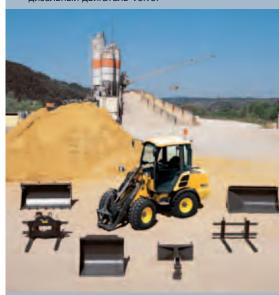
Фирменный гидрозамок навесного оборудования позволяет использовать широкий спектр навесного оборудования на машине.
