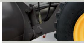
Делайте больше работы благодаря третьему гидравлическому контуру.
