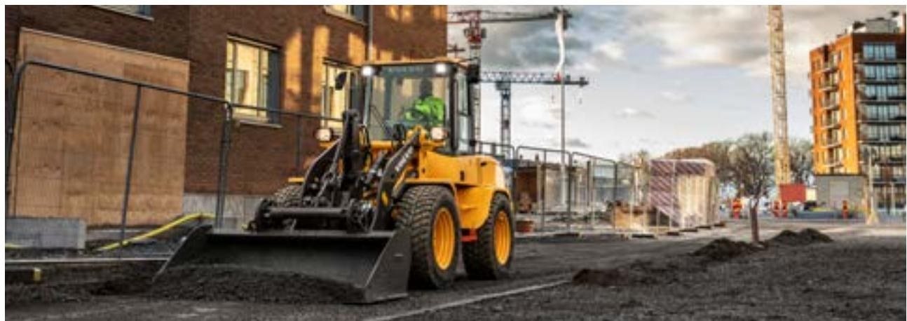
Skuffen kommer med en forhåndsboret kniv laget av Hardox 400-stål. Den kan utstyres med 1 eller 3-delt Bolt On-slitestål av Hardox 400 som ekstrautstyr. Slitedeler finnes på side 24.
