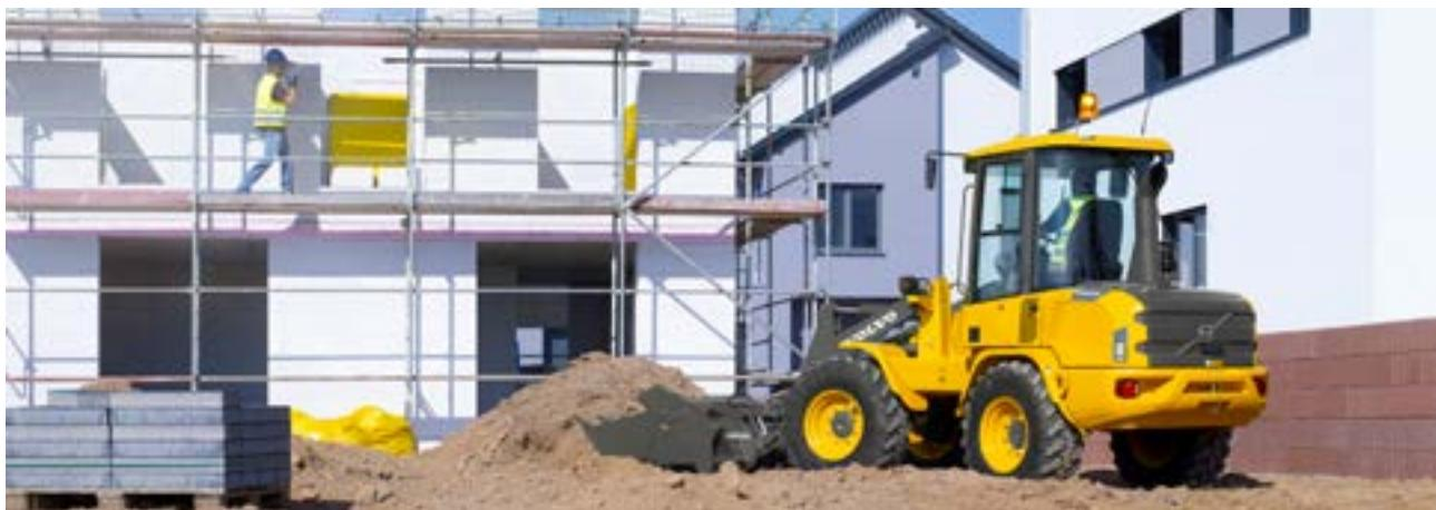
Skuffen leveres med sveisede adapttere og tenner, eller en forhåndsboret kniv laget av Hardox 400-stål. Den kan utstyres med 1 eller 3-delt Bolt On-slitestål av Hardox 400 som ekstrautstyr. Slitedeler finnes på side 24.
