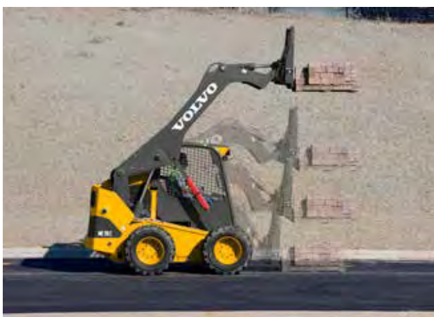
Elevador paralelo (o acessório permanece paralelo ao solo durante todo o ciclo de elevação)
