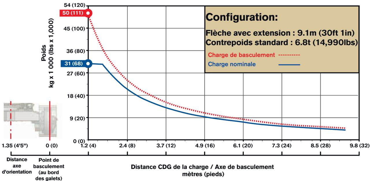
\* Remarque : charge de basculement max. selon les normes ISO 8813, SAE J743 et ASME B30.14.
