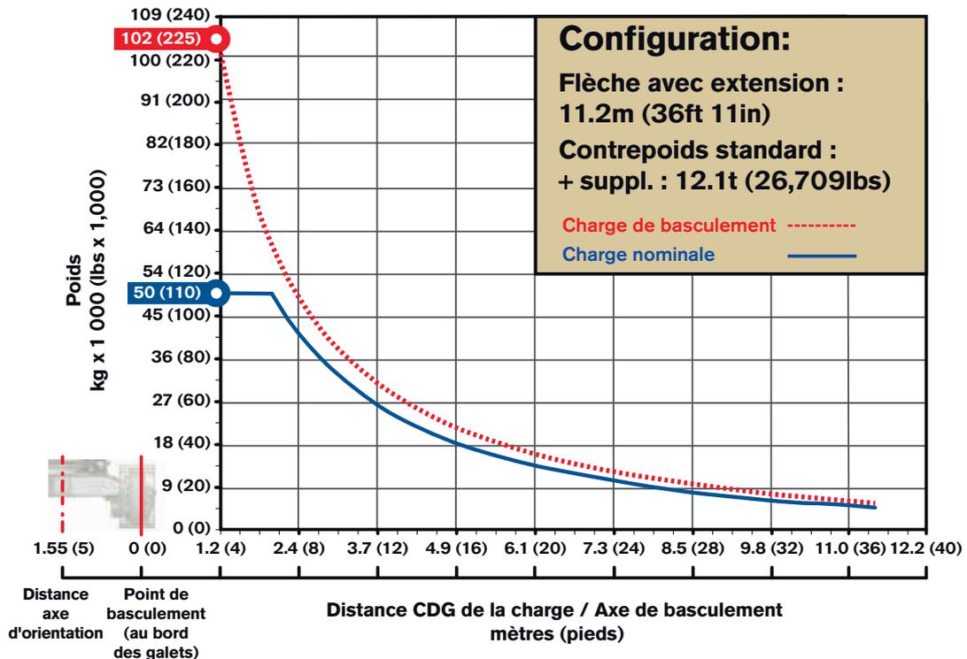
\* Remarque : charge de basculement max. selon les normes ISO 8813, SAE J743 et ASME B30.14.
