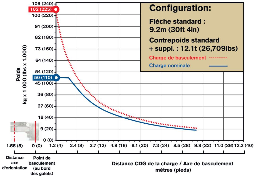
\* Remarque : charge de basculement max. selon les normes ISO 8813, SAE J743 et ASME B30.14.
