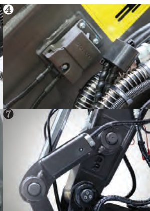
④ アーム、ブーム、フレーム、 ⑤ バケットリンク IMU (角度センサー)
