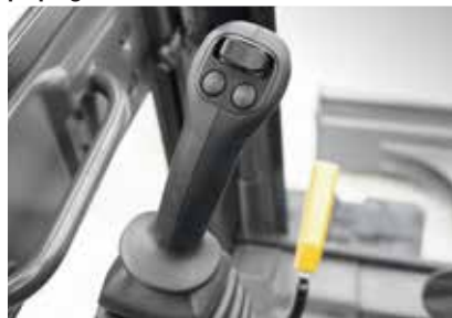
Comutator electric pentru lama de buldozer, pe pârghia de comandă
