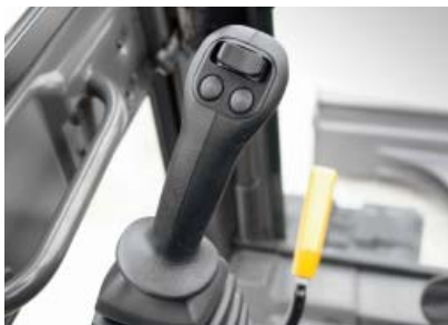
Sähköinen puskulevyn kytkin ohjaussauvassa
