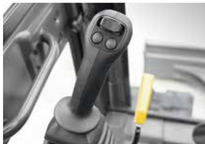
Schalter am Joystick für elektrisches Planierschild
