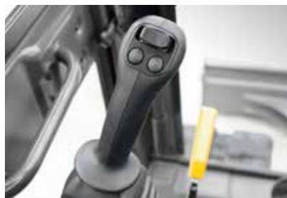
Schalter am Joystick für elektrisches Planierschild
