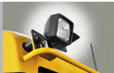
Дополнительное рабочее освещение
