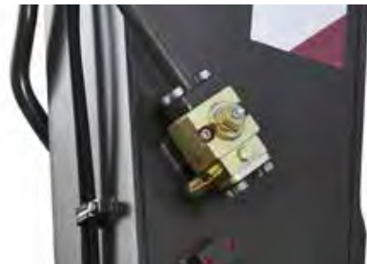
Conduites broyeur/cisaille (x1)
