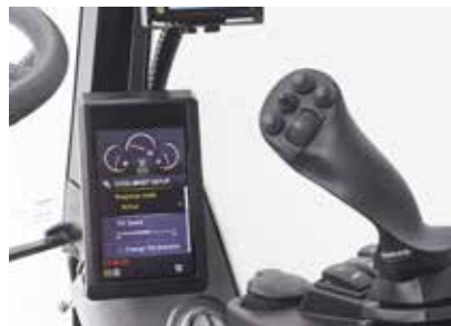
Tiltrotatorns joystickar och skärm
