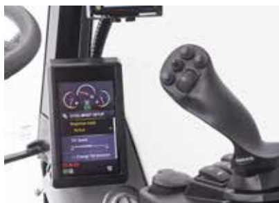
Tiltrotatorns joystickar och skärm
