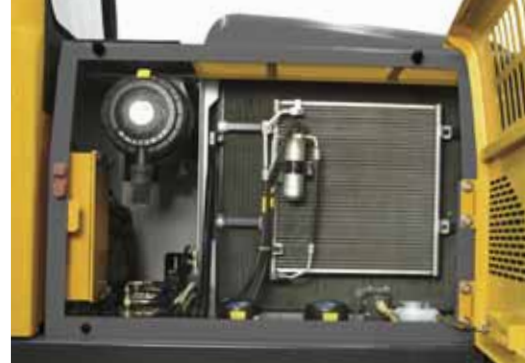
• Упрощенный доступ с уровня земли для технического обслуживания.
