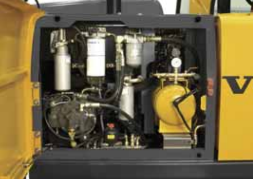
• Удобный доступ к фильтрам гидравлической жидкости.
