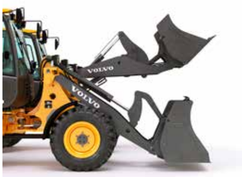
Choix entre cinématique parallèle ou articulation en Z (L25 Electric)
