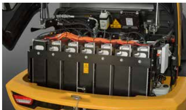
Choix bloc-batterie de 33 kWh ou de 40 kWh (L20 Electric)
