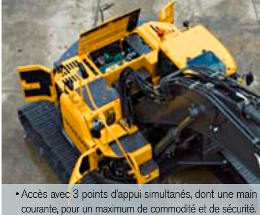
• Accès commode par une grande ouverture aux distributeurs hydrauliques depuis le niveau du sol.
