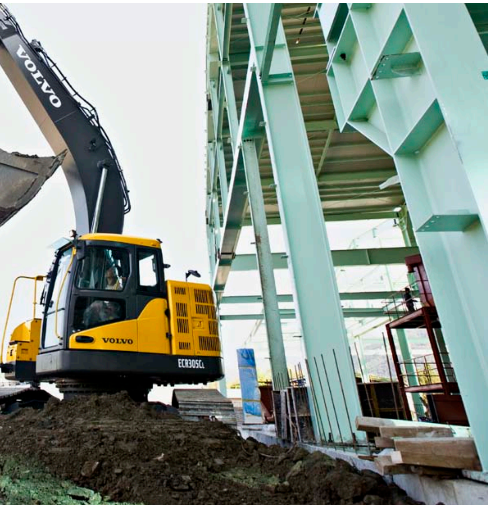
• Accès avec 3 points d'appui simultanés, dont une main courante, pour un maximum de commodité et de sécurité.
