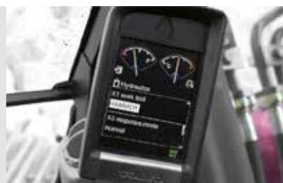
Marteau et cisaille : préréglage variable du débit et de la pression
