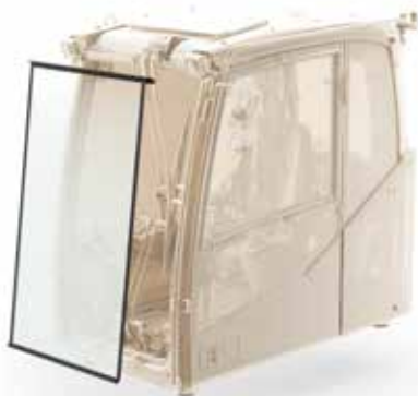
Parabrisas delantero de una pieza de alta resistencia
