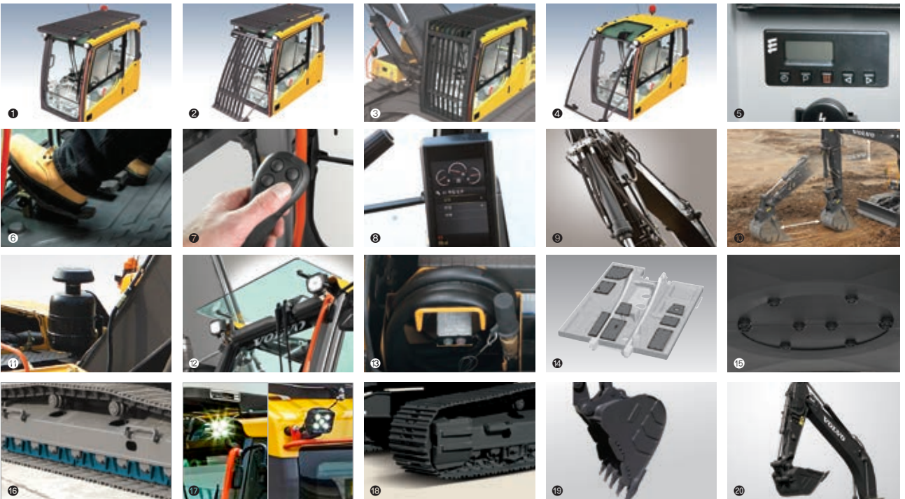
① 상부 보호 가드 ② 캡 보호 가드(캡 장착식) ③ 캡 보호 가드(프레임식) ④ 전면 스크린 ⑤ 냉각수 히터 ⑥ 일체형 주행 페달 ⑦ RCV레버(4버튼/롤방식/숫컷기능) ⑧ 어태치 매니지먼트 시스템 ⑨ 다양한 유압배관 ⑩ 붐 플로팅 기능 ⑪ 오일배스 크리너 ⑫ 섀시라이저 ⑬ 연료 주입펌프 ⑭ 험지용 상부 언더커버 ⑮ 험지용 하부 언더커버 ⑯ 험지용 폴 트랙가드 ⑰ LED 램프 ⑱ 험지용 슈(3-gr) ⑲ 다양한 버켓 ⑳ 다양한 붐&암
