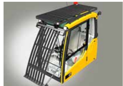
Grade de proteção contra queda de objetos instalada na cabine (FOG)
