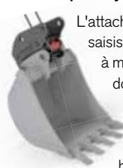
L'attache rapide à axe de Volvo saisissent tous les accessoires à montage direct de Volvo, dont les brise-roche, pinces et godets, qui peuvent être utilisés en position pelle en butte ou normale.
