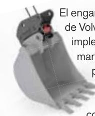
El enganche rápido de pasador de Volvo permite conectar implementos Volvo, como martillos hidráulicos, pulgares y cucharas, para su utilización tanto en la posición frontal como en la posición normal.
