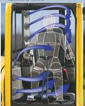
O aquecimento e o ar condicionado mantêm o operador confortável.
