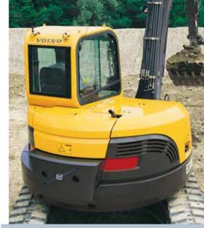
O raio de rotação reduzido oferece máxima capacidade de manobra.
