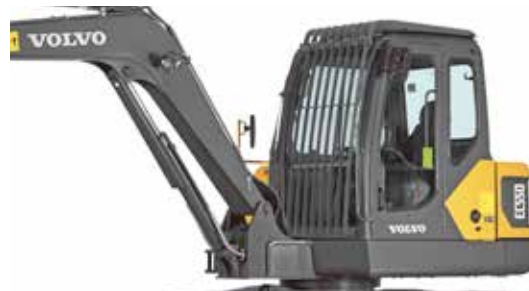
Grade de proteção contra queda de objetos instalada na cabine (FOG)
