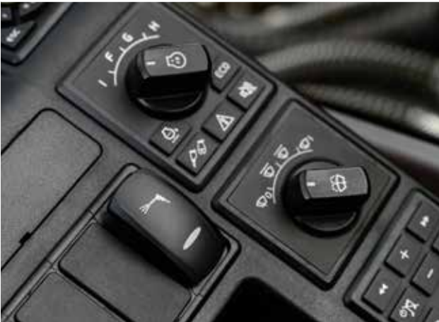
Sistema di abbattimento della polvere - Modalità Automatica/Manuale selezionabile
