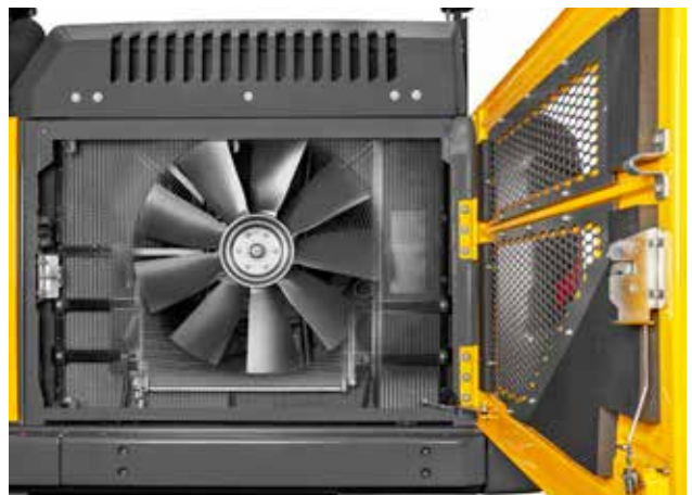
Ventola di raffreddamento con inversione del senso di rotazione
