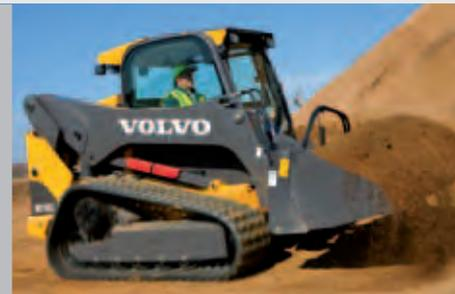
El soporte de implementos hidráulico Volvo permite al operador cambiar el implemento desde el asiento (incluido en el Paquete de lujo)
