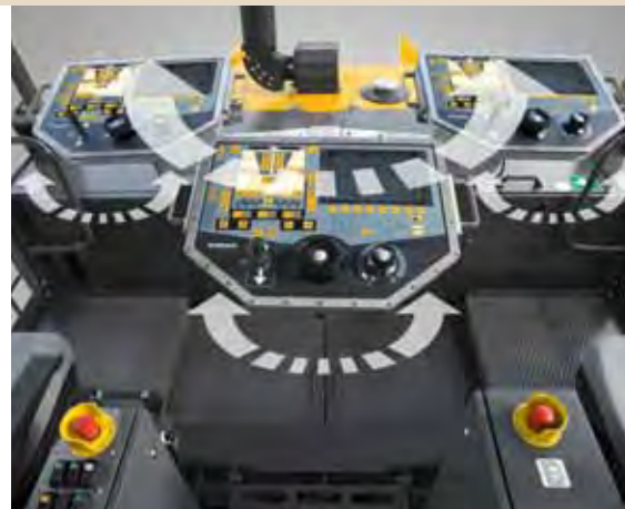
• Painel de controle giratório do EPM.
