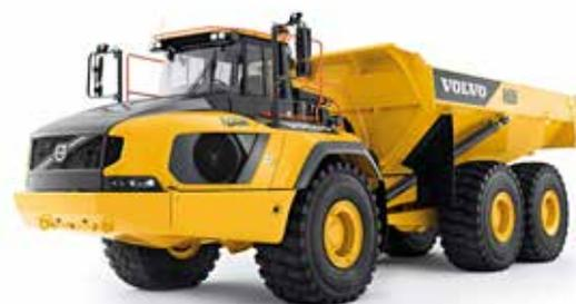
Самосвал Volvo A60H, созданный на основе проверенной временем технологии Volvo, с сочлененным рулевым управлением, полным приводом и блокировкой дифференциалов стал еще больше и мощнее.
