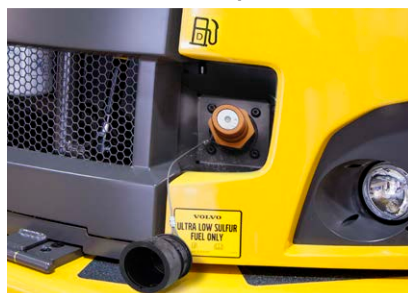
Sistema di rifornimento rapido
