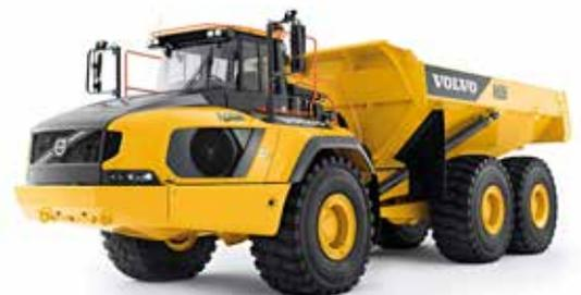
Самосвал Volvo A60H, созданный на основе проверенной временем технологии Volvo, с сочлененным рулевым управлением, полным приводом и блокировкой дифференциалов, стал еще больше и мощнее.
