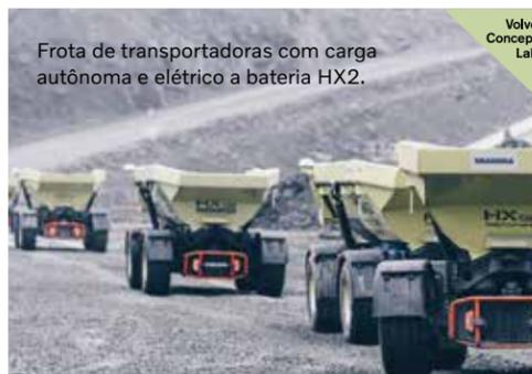
Frota de transportadoras com carga autônoma e elétrica a bateria HX2.
