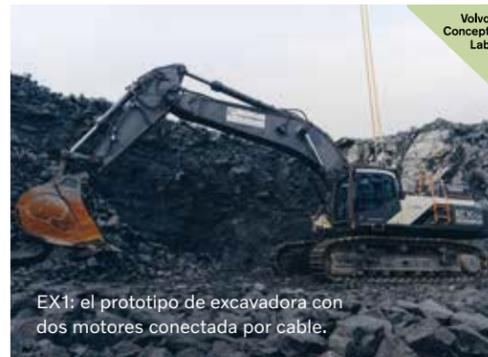
EX1: el prototipo de excavadora con dos motores conectada por cable.
