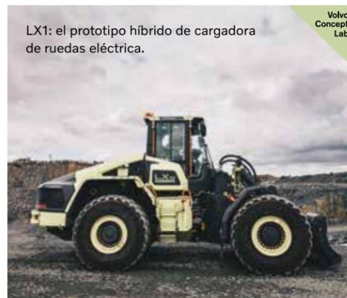
LX1: el prototipo híbrido de cargadora de ruedas eléctrica.
