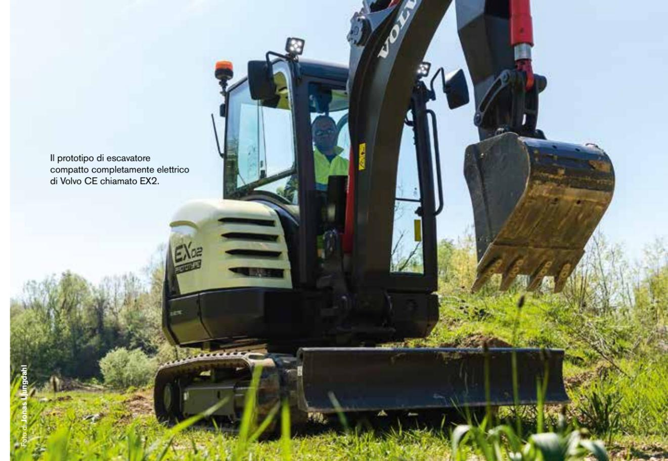
Il prototipo di escavatore compatto completamente elettrico di Volvo CE chiamato EX2.
