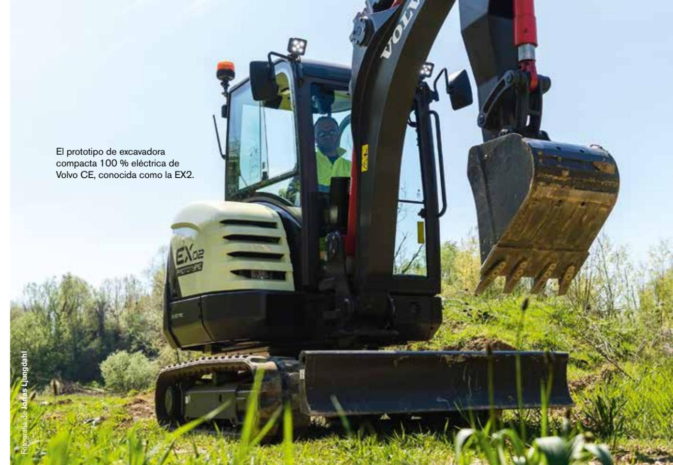
El prototipo de excavadora compacta 100 % eléctrica de Volvo CE, conocida como la EX2.
