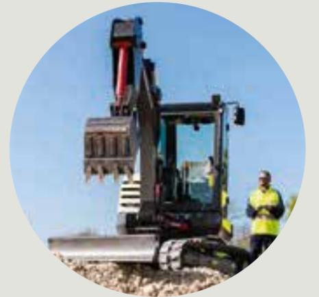
Scopriamo EX2, il più recente prototipo creato dal Volvo Concept Lab. Questo escavatore compatto completamente elettrico è più pulito, silenzioso ed efficiente dei modelli convenzionali.
