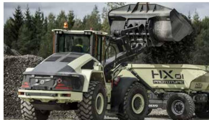
Presentazione del concetto di veicolo portacarichi HX1 con alimentazione a batteria-elettrica e del prototipo di pala gommatto elettrica ibrida LX1 durante l'Xploration Forum a Eskilstuna, Svezia
