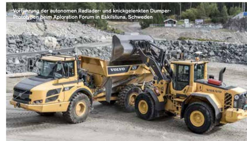
Vorführung der autonomen Radlader- und knickgelenkten Dumper-Prototypen beim Xploration Forum in Eskilstuna, Schweden
