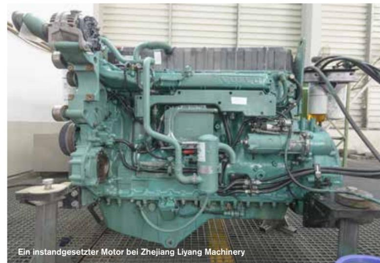
Ein instandgesetzter Motor bei Zhejiang Liyang Machinery
